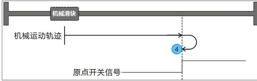
原点开关位于机械负方向/正方向。机械往原点开关方向运动，当检测到原点开关后减速停止，再反转退出原点开关，找原点开关信号下降沿位置记录为原点，电机立即停止。
